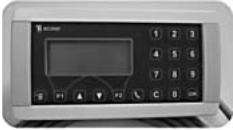
Fronte del computer di bordo: display e tastiera
